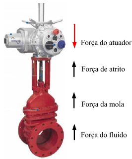
Figura 2: Diagrama de forças presentes no modelo de atuador/válvula/tubulação.
